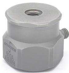
910A系列产品是一款专为加速度传感器的标定和校准设计的比较标准传感器。该产品采用压缩模式工作的石英晶体为敏感元件，同时外壳采用316L不锈钢激光焊接密封设计，具有平坦的高频响应特性和输出保持长期稳定的特性，非常适合用于振动或冲击加速度传感器的标定/校准用标准传感器。910A产品提供1/4-28的螺孔，支持顶端或底面安装（即振动器端或加速度传感器测试端安装）。910A产品结构采用扁平化设计，具有极佳的信号传导能力；同时得益于独创的石英晶体结构设计，使得产品具有低基座应变灵敏度、高谐振频率点和非常优秀的输出长期稳定的特性。产品信号地与外壳相连，可提供绝缘垫片。产品信号通过10-32的连接头输出，需与同轴线缆配合进行测量使用，森瑟科技提供与之互配的线缆，型号：11-L，具体参见配件表格。
