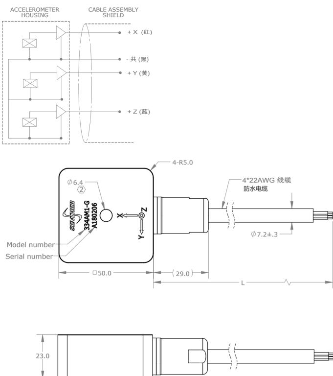
334AM1系列产品是一款高/低频振动测量用防水型三轴加速度传感器，其特点是采用环形剪切模式的陶瓷晶体为敏感元件，具有长期保持输出稳定的特性。此加速度传感器的内部电路是在IEPE系统的两线制上同时提供恒流激励和传输低阻抗电压输出信号，信号地内部屏蔽，并与外壳隔离；同时信号放大电路设计考虑了极性反向保护。外壳采用激光焊接工艺以保证产品的密封性，整线输出的封装设计保证了产品工作时的长期稳定性；334AM1系列加速度传感器支持粘合剂安装，也提供了Ø6.4 的中心通孔进行螺丝安装。334AM1系列加速度传感器具有低频响应和抗冲击的特性，适用于偶发冲击环境下高层建筑振动监控。
